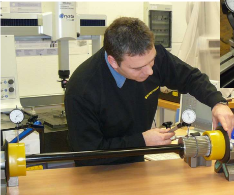
检测输送辊轮跳动
