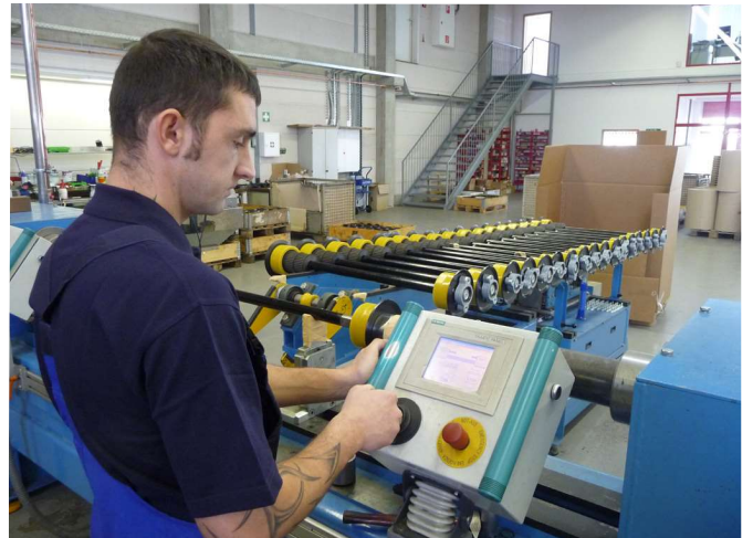
使用卧式压力机装配模块化输送辊轮
