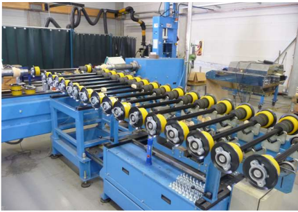
输送辊轮自动化装配线
